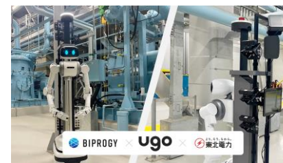
発電所内を目視による定常点検をugoで代替
