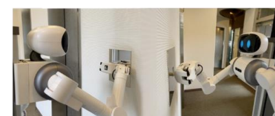
発電所内を目視による定常点検をugoで代替
