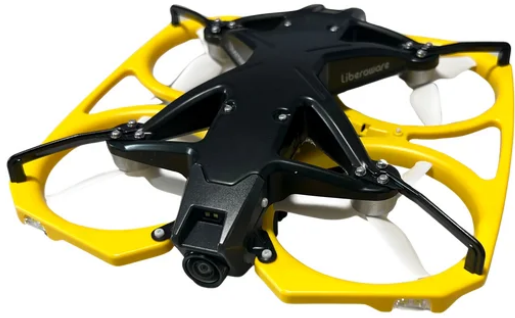
ドローン内のCFRP部品をNFRP部品に換装
