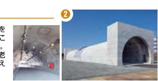
トンネル内の交通事故や崩落、老朽化を再現するほか、両側のシャッターを閉鎖することで、長いトンネルの中央部も再現できます。ロボットを用いた状況確認・瓦礫除去、老朽化点検試験や操縦訓練・救助訓練が行えます。
