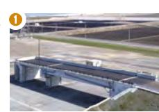
橋の老朽化(コンクリートのひび割れや剥離、ボルトのゆるみ等)や障害物を再現しています。ドローン等を用いた状況確認・点検試験や操縦訓練が行えます。
