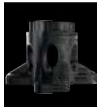
ULTEM™ 9085 フィラメントと連続カーボンファイバーを組み合わせると、高い強度を備えた航空宇宙グレードの複合材パーツを製造できます。
