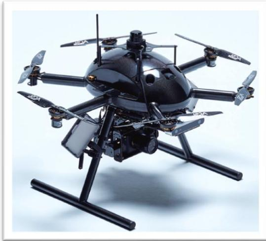
✦ 飛行制御が難しい煙突内の非GPS環境下でも、LiDARによる安定した自律飛行によって楽々点検が可能です！
