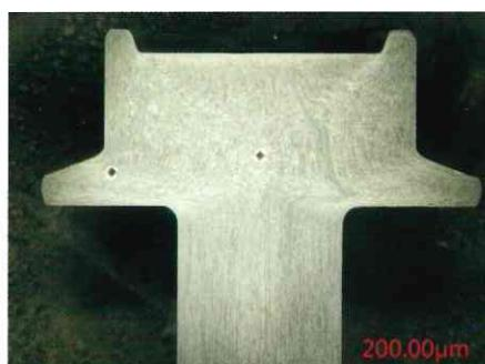
M6 の六角フランジボルトの頭部および首下部分の断面写真です。当然、フローラインが断続することなく、内部に空間(す)も発生していません。高い冷間加工技術とノウハウによるものです。(中央と左フランジ部分の点は硬度測定用のマークです。)
